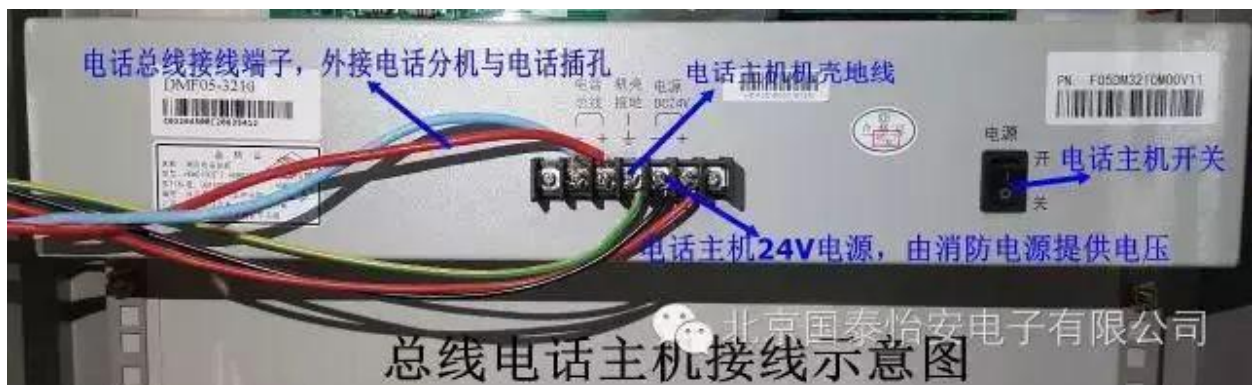
上图电话主机接线示意图 (该电话主机为豪沃尔 HDM3210)
