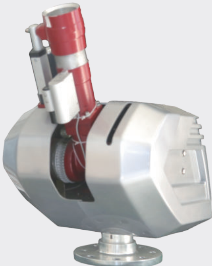
ZDMS0.8/20S-HDZS604 自动跟踪定位射流灭火装置 是一种大流量远距离探测定位的自动消防炮 (以下简称自动消防炮)。该产品通过双微机控制, 综合运用紫外和红外传感技术, 能够及时探测出早期火灾并能准确定位火源, 并可以通过彩色摄像头观察现场状况, 联动控制外围设备 (水泵、电动阀等) 进行射水灭火, 水量大距离远, 灭火效果好。
